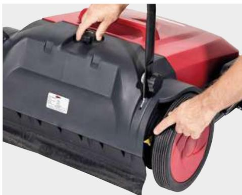
La spazzola principale è guidata meccanicamente dalle ruote, consentendo in questo modo alla spazzola principale di essere sempre ben funzionante, a prescindere che la macchina giri a sinistra o a destra. Quando la macchina viene spinta indietro, le ruote non trasmettono alcun movimento alla spazzola principale.
