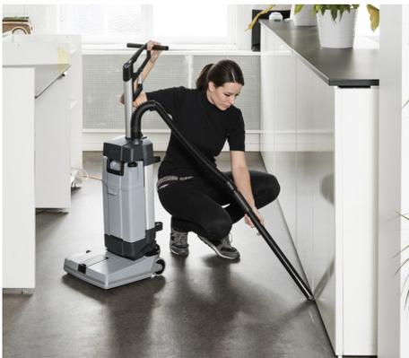
Il tubo di aspirazione manuale può essere utilizzato per l'aspirazione di acqua/soluzione detergente in aree che non si possono raggiungere con la macchina
