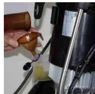
Serbatoio dell'olio ispezionabile dall'esterno con indicatore di livello
